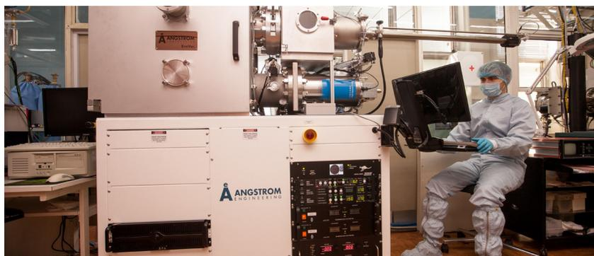
Установка напыления тонких магниторезистивных слоев Angstrom EvoVac-34
