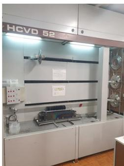
Установка плазмохимического осаждения HCVD-52
