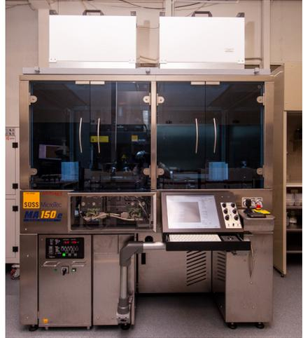
Установки нанесения и проявления фоторезиста Suss Microtec Gamma 4m и MA-150e
