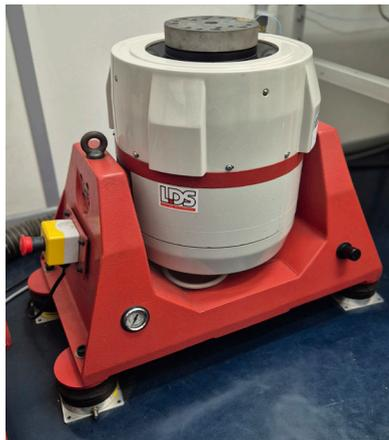
Вибростенд электродинамический LDS-Dactron V650
