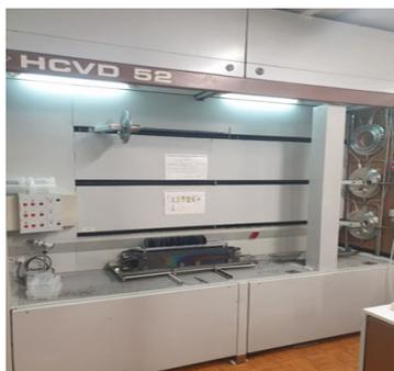
Установка плазмохимического осаждения HCVD-52
