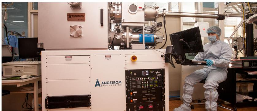
Установка напыления тонких магниторезистивных слоев Angstrom EvoVac-34
