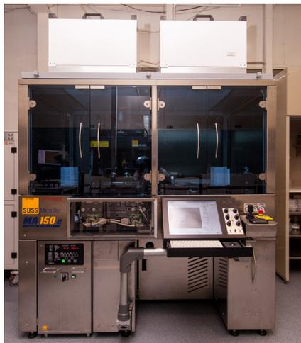
Установки нанесения и проявления фоторезиста Suss Microtec Gamma 4m и Ma-150e
