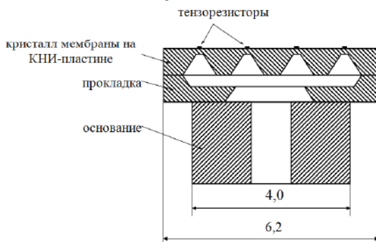
Рисунок 1. Эскиз конструкции ЧЭ высокотемпературного преобразователя давления
